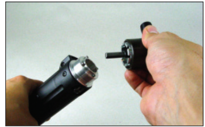
2a. Kopf komplett entfernen
