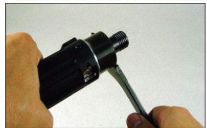
4. Überwurfmutter mit Nasenschlüssel anziehen
