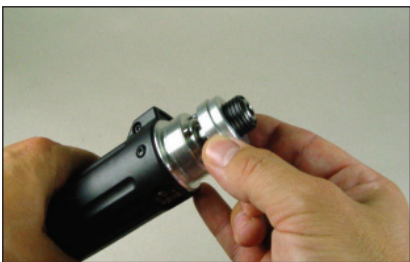
3. Antriebswelle ADAPT-STAB-1 einstecken
