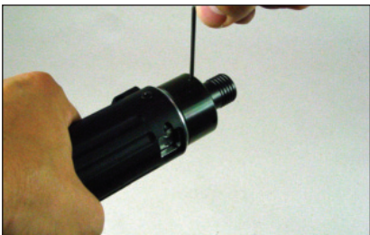
5. Zum Schluss mit Gewindestift sichern
