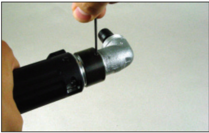
1. Lösen des Sicherheitsstiftes mit einem Imbusschlüssel
