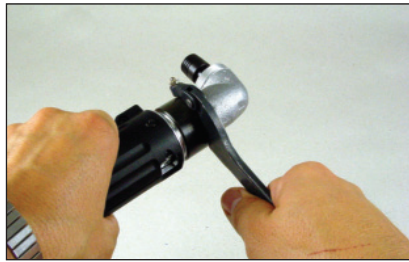
2. Überwurfmutter lösen mit einem Nasenschlüssel
