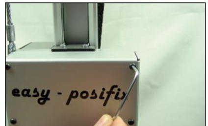
9. Schließen des Gehäuses mit einem Imbusschlüssel
