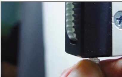
7. Die Umlenkrolle sollte ein Spiel von 1mm bis zum Anschlag haben
