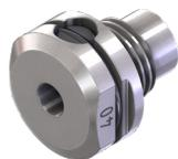
Das patentierte System der Festhaltemundstücke ist optimal zum Senkrechtennieten oder für schwer erreichbare Stellen geeignet, da der Niet im Mundstück festgehalten wird. Der Nietdorn kann nach dem Nietvorgang nicht in das Werkstück fallen.
