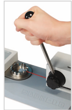
^ Der ergonomische Zughebel bringt die Kraft auf und lässt die Probe wieder frei.
