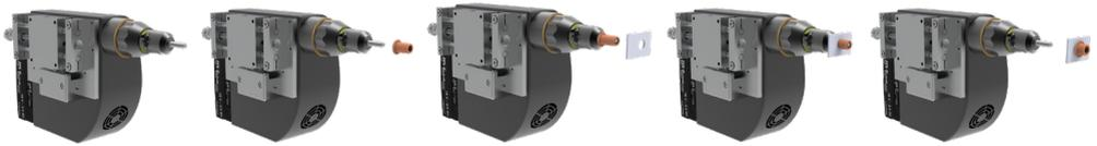
1. Zuerst muss der RoboRiv in Position zum Aufspindeln gebracht werden. Dazu muss der RoboRiv auf die Blindnietmutter zugefahren werden, bis der Gewindedorn aufliegt und die Kompensationseinheit sich mittig in der Führung befindet. Wenn dies geschieht, liegt ein Signal auf dem Positions Pin an.
