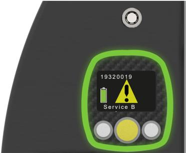
Die Servicezähler können mit dem HST-Tool-Manager unter dem User „Service“ parametrierbar werden. Der jeweils eingetragene Wert wird mit 1.000 multipliziert, d.h. bei Eintragung 10 erscheint nach 10.000 Setzungen der Servicehinweis auf dem Display. Mit Eintragen einer 0 wird die Funktion deaktiviert.
