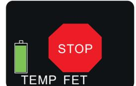
Ein Weiterarbeiten ist erst nach Abkühlung möglich, um das Werkzeug vor bleibenden Schäden zu schützen.
