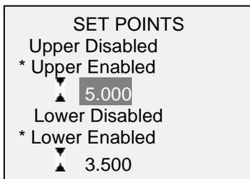
Es können entweder einer, zwei oder keiner der Sollwerte aktiviert werden. Mit der Taste **DIRECTION** kann zwischen den Messrichtungen Zug und Druck umgeschaltet werden.
