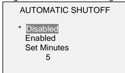
Um die automatische Abschaltung zu deaktivieren, wählen Sie **Disabled** (Deaktiviert). Um die automatische Abschaltung zu aktivieren, wählen Sie **Enabled** (Aktiviert). Die Dauer der Inaktivität wird über den Parameter **Set Minutes** (Minuten einstellen) in Minuten konfiguriert. Mögliche Einstellungen: 5–30, in 5-Minuten-Schritten
