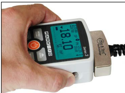
Abb. 3.2 Zum Lösen des Plug & Test™-Steckers die beiden Knöpfe auf beiden Seiten des Gehäuses des Messgeräts drücken.
