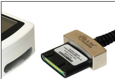
Abb. 3.1 Korrekte Ausrichtung des Plug & Test™-Verbindungssteckers. Auf den Typenschildern auf dem Stecker sind Modellnummer, Seriennummer und Lastbereich des Sensors angegeben.
