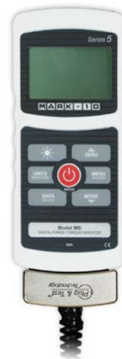
Sensorstecker unten angeschlossen
