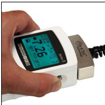
Abb. 3.2 Zum Lösen des Plug & Test™-Steckers die beiden Knöpfe auf beiden Seiten des Gehäuses des Messgeräts drücken.
