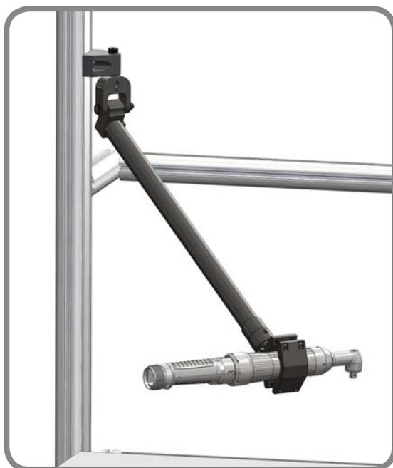
Wird verwendet wenn die Drehmoment-Achse senkrecht zur Arm-Achse ist.
