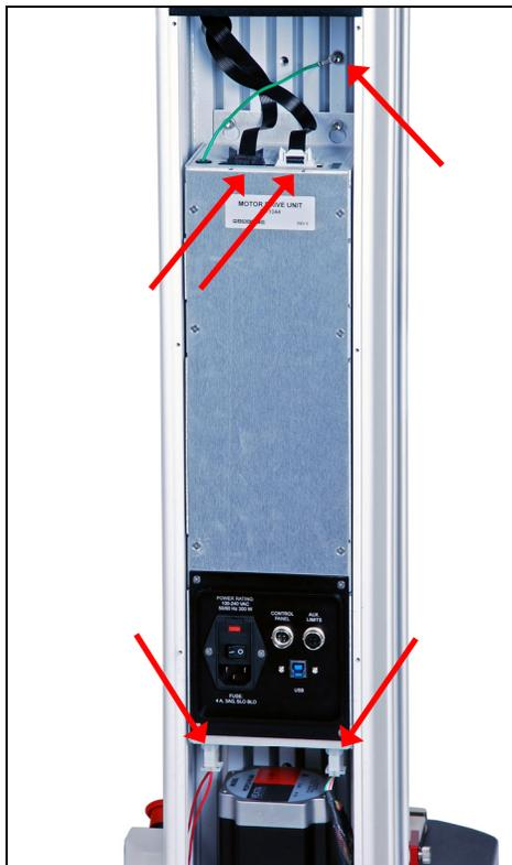
4. Lösen Sie die vier Schrauben, die die MDU am Rahmen befestigen, etwas, heben Sie die MDU leicht hoch und ziehen Sie, wie in der Abbildung unten dargestellt, heraus:
