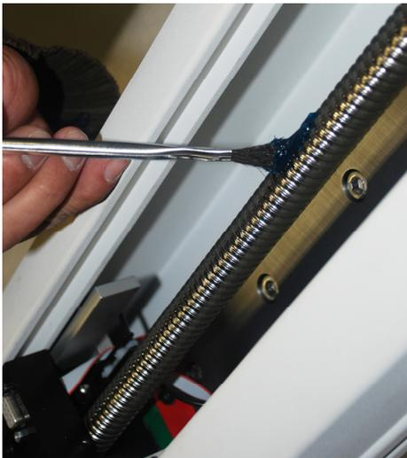
3. Bewegen Sie den Kreuzkopf mehrere Male nach oben und unten, bis das neu aufgetragene Fett gleichmäßig über die Länge der Schraube verteilt wurde.
