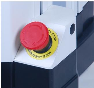
Der Notaus-Schalter befindet sich auf der Basis, neben der rechten unteren Ecke der Säule, wie im Bild links abgebildet.
